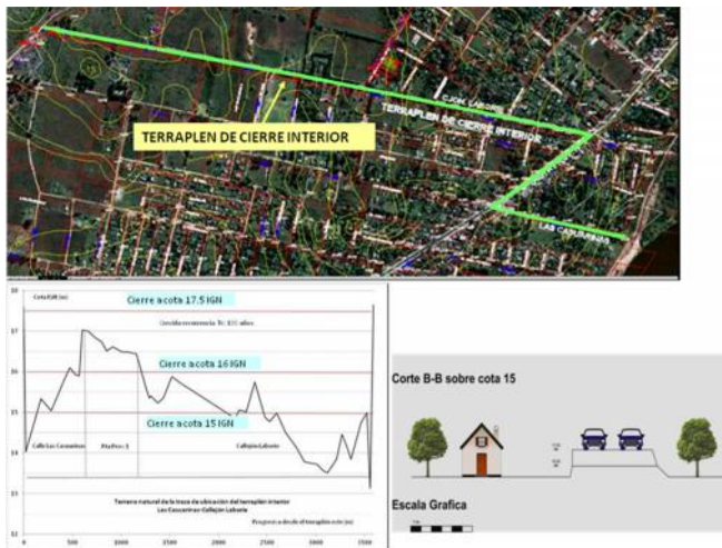
Figura Nº 7. Traza del terraplén interior
